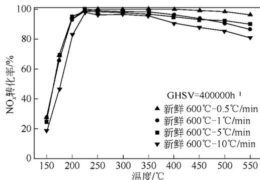
图 6 不同升温速率下 600 焙烧制备 Cu<sub>3.9</sub>-SSZ-13 催化剂的 NH<sub>3</sub>-SCR 活性差异
