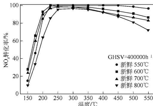
图 3 不同焙烧温度下制备 Cu<sub>3.9</sub>-SSZ-13 催化剂的 NH<sub>3</sub>-SCR 活性差异
