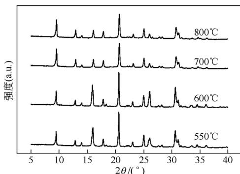
图 2 不同焙烧温度所得 Cu-SSZ-13 的 XRD 图谱
