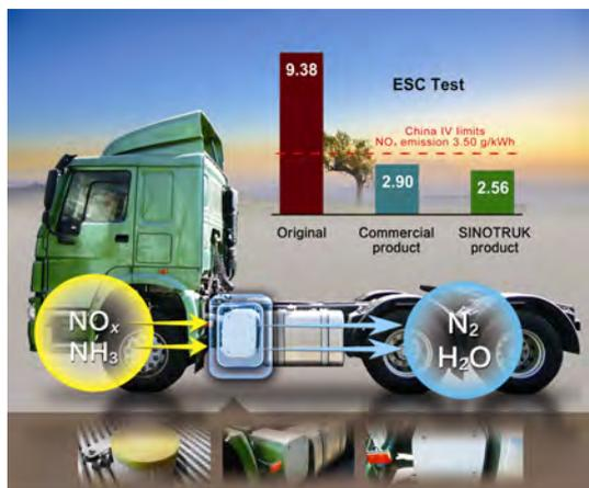
**封面:** 贺泓及研究团队基于实验室对 V<sub>2</sub>O<sub>5</sub>-WO<sub>3</sub>/TiO<sub>2</sub> 催化剂配方及涂覆成型技术的大量研究, 在中国重汽集团建成了一条 NH<sub>3</sub>-SCR 催化剂生产线, 产品满足国产重型柴油车国 IV 排放标准要求. 见本期第 1438-1445 页.
